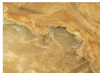
Bề mặt dầu sau 10 phút khi phun CPT-CPSE
