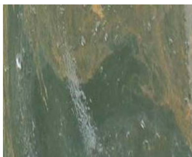
Bề mặt dầu sau 2 phút khi phun SD-25
