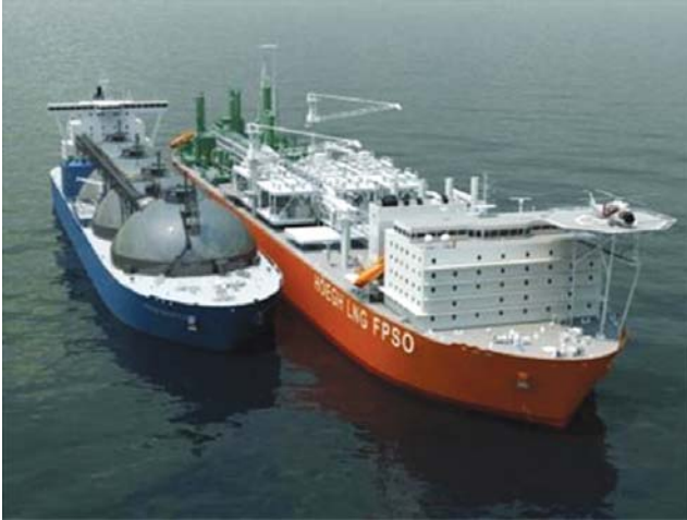
Hình 4. Xuất khí hóa lỏng từ FLNG sang LNGC kiểu cập mạn
