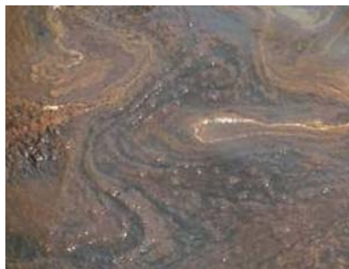
Bề mặt dầu sau 5 phút khi phun SD-25
